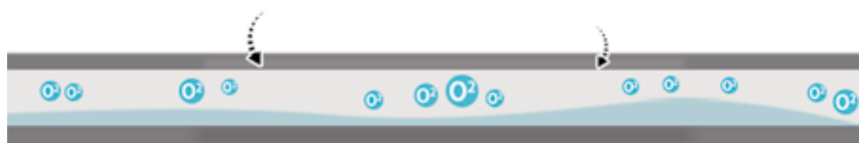
Коэффициент проницаемости кислорода обычных пластиковых труб более 0,5.
